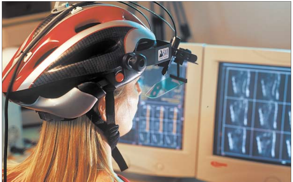
In den Cure-Usability-Labs werden unterschiedlichste Szenarien simuliert; so kann mit dem sogenannten „Eye-Tracking“ festgestellt werden, wie ein Benutzer Bildbewegungen verfolgt. Foto: CURE
