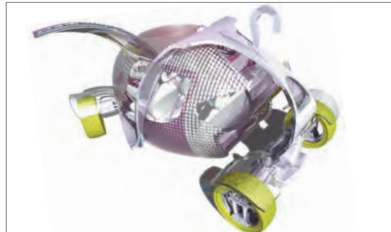
Herzstück dieser Architekten-Autoträume sind omnidirektionale Roboterräder, die Elektromotoren enthalten. Foto: MIT
